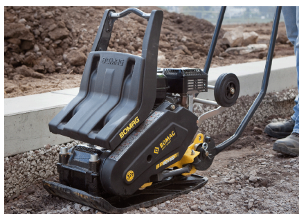
Robusto e affidabile Cinghia trapezoidale completamente protetta da deterioramento
