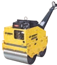
BW 75 H Peso operativo: 1.040 kg Forza centrifuga: 40 kN Larghezza di lavoro: 750 mm
