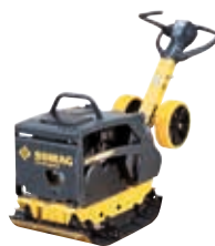
BPR 25/50 Peso operativo: 140 kg Forza centrifuga: 25 kN Larghezza di lavoro: 500 mm
