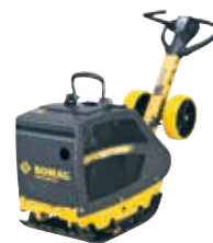
BPR 35/42 D Peso operativo: 210 kg Forza centrifuga: 35 kN Larghezza di lavoro: 420 mm
