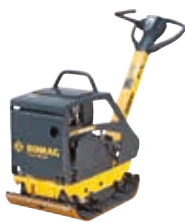
BPR 25/40 D Peso operativo: 150 kg Forza centrifuga: 25 kN Larghezza di lavoro: 400 mm
