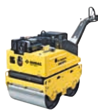
BW 65 H Peso operativo: 757 kg Forza centrifuga: 22 kN Larghezza di lavoro: 650 mm
