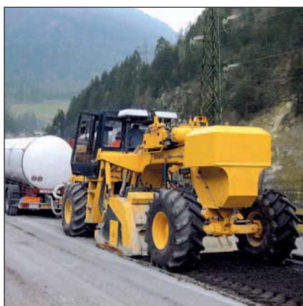
Aggiunta contemporanea di cemento e bitume schiumato.
