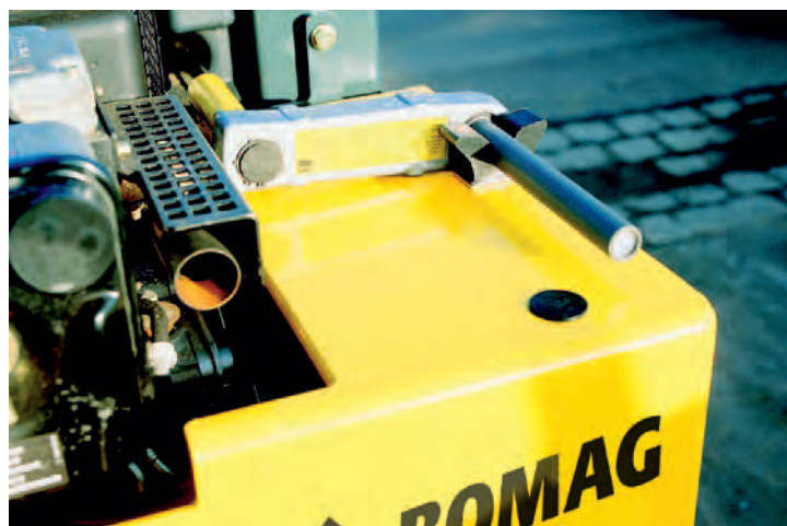
Avviamento elettrico e manovella di avviamento di serie per il massimo comfort e la massima disponibilità possibile.
