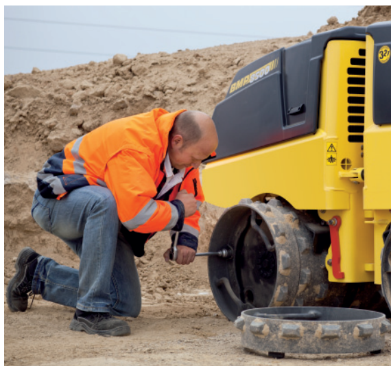
Allargamenti dei tamburi su richiesta per un cambio rapido della larghezza di lavoro in caso di scavi di piccole e grandi dimensioni.
