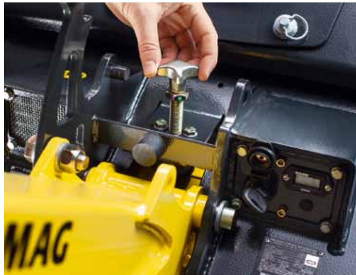
Il timone regolabile in altezza: comfort di serie per tutte le piastre BPR.
