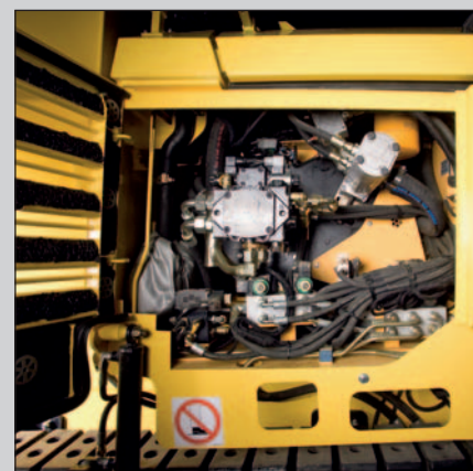
Impianto idraulico centrale facilmente accessibile – pompe, valvole, raccordi, ecc. a portata di mano.
