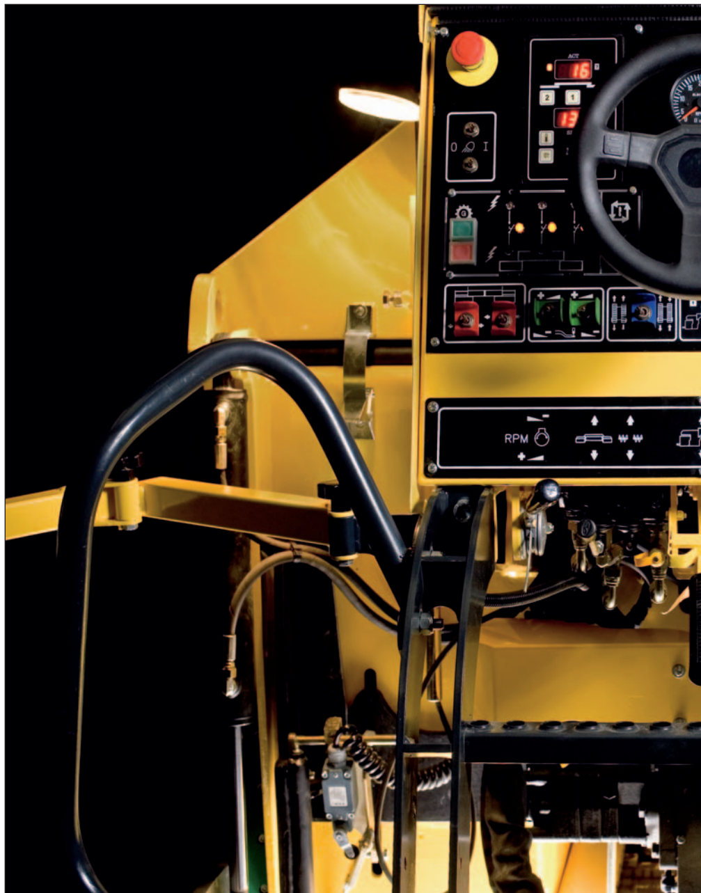
La console principale della BF 223 C con riscaldamento elettrico del banco.
