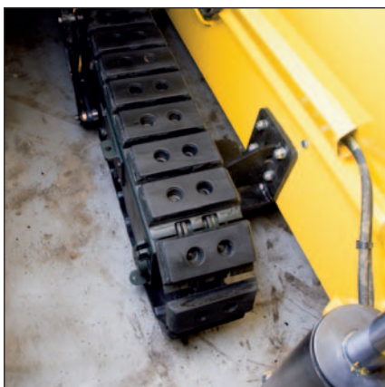
Pattini dei cingoli in gomma avvitati – maggiore trazione, protezione in prossimità dei cordoli e manutenzione più semplice.
