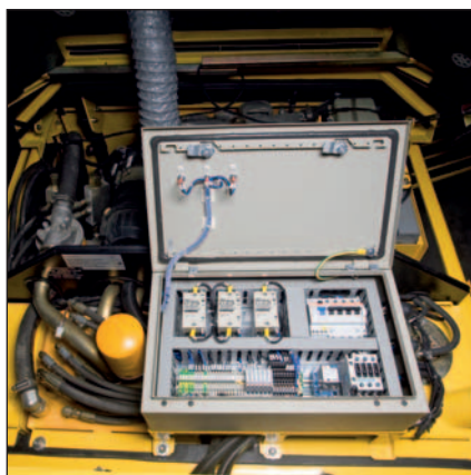
Il dispositivo di controllo della macchina è alloggiato in un quadro elettrico centrale, protetto, facilmente raggiungibile.
